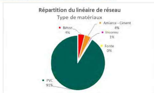
Figure 4: Répartition du linéaire du réseau d'assainissement en fonction du type de matériaux
